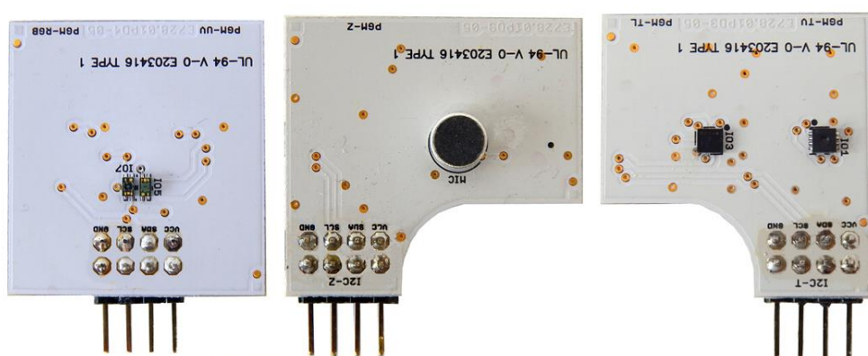
Obr. 3: Jednotlivé sensorové elementy – VIS/UV, hluk, teplota/RH a tlak.
